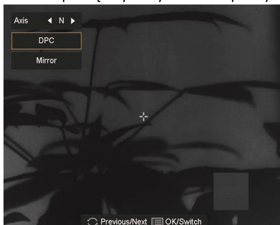
Rysunek 3-4 Korekcja wadliwych pikseli
